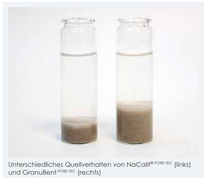
Unterschiedliches Quellverhalten von NaCalit® PORE-TEC (links) und GranuBent® PORE-TEC (rechts)
